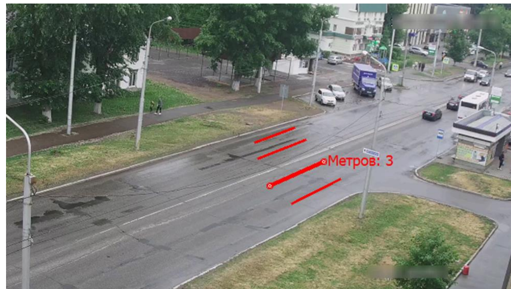
Рисунок 12. Пример созданных линий дороги для ПМ «Детектор объектов по габаритам и типам»
